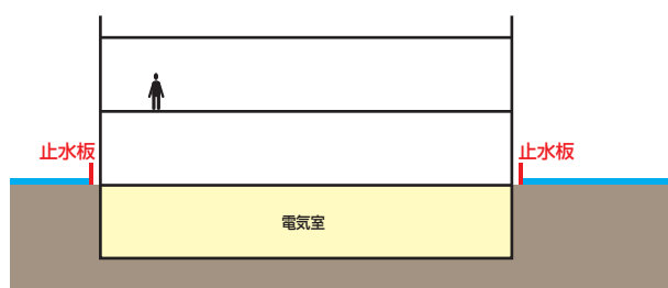
<止水板で建物内への浸水を防止>
