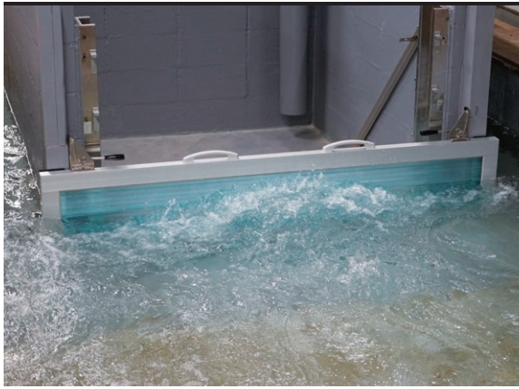
金属止水板と同等の水圧に耐えます。
