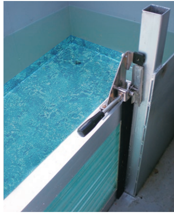
パネル内に水が流入して自重が重くなることで、底面の止水パッキンが押し潰され、さらに止水性が向上します。
